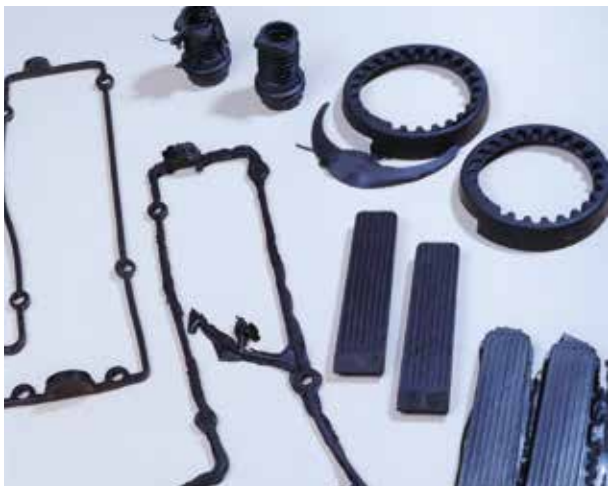
Gummitteile vor und nach der Entgratung
